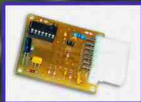
"Блок зажигания — регулятор угла ОЗ на микроконтроллере PIC16F676"
